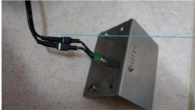
Conectar os terminais do cabo nos terminais da chave (qualquer posição).
